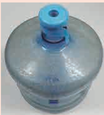
正常ボトル（青色） 屋外保管で生じた退色劣化
